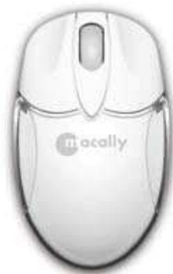
El ratón es el periférico de entrada más utilizado para el manejo de Windows. Su utilización consiste en desplazarlo, horizontal o verticalmente, sobre una superficie, coincidiendo este desplazamiento con el movimiento del puntero del ratón en la pantalla de nuestro ordenador.
